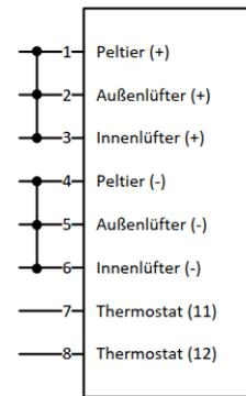
Gebrückte Klemmen sind ab Werk mit Wago 231-903 Brücken versehen & müssen bei Bedarf kundenseitig angepasst werden. Der maximale Leiterquerschnitt beträgt 1,5 mm<sup>2</sup> mit Brücke und 2,5 mm<sup>2</sup> ohne Brücke.
