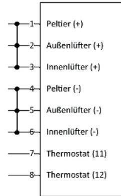
Gebrückte Klemmen sind ab Werk mit Wago 231-903 Brücken versehen & müssen bei Bedarf kundenseitig angepasst werden. Der maximale Leiterquerschnitt beträgt 1,5 mm<sup>2</sup> mit Brücke und 2.5 mm<sup>2</sup> ohne Brücke.
