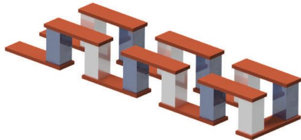
Bei **Peltierkühlern** wird der Energie- und somit Wärmefluss durch elektrischen Strom bewerkstelligt. Dieser entspricht dem Kältemittel des Kompressors, die Gleichspannungsquelle dem Kompressor.
